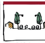
Problème d'échelle : des constructions basses le long de la voie - la voie conserve un caractère routier
